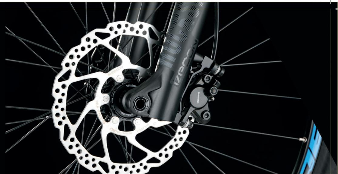
E-THRU AXLE SHIMANO HUBS AND ROCK SHOX FORK
